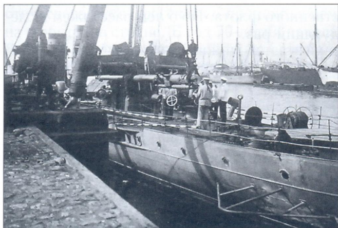
Монтаж 102-мм орудия на «Добровольце» – перед Первой мировой войной вооружение эсминцев усилили, заменив 76-мм орудия на пару более мощных пушек
