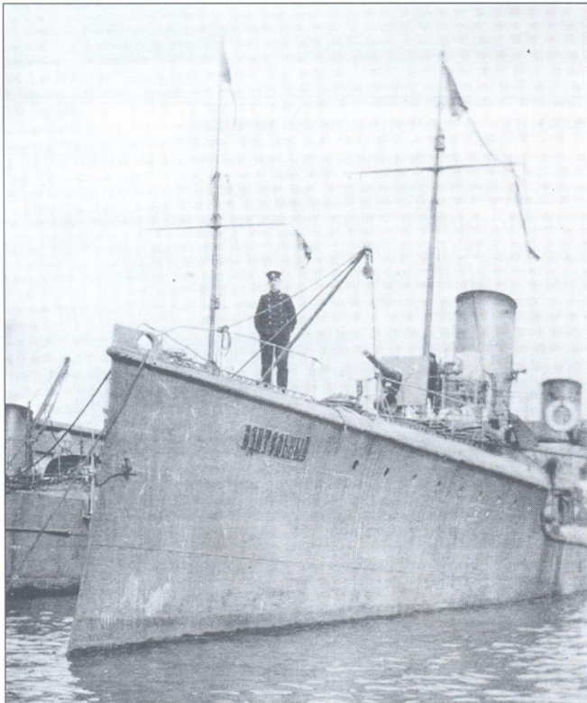
Возвышенный полубак — отличительная черта миноносцев немецкой постройки
